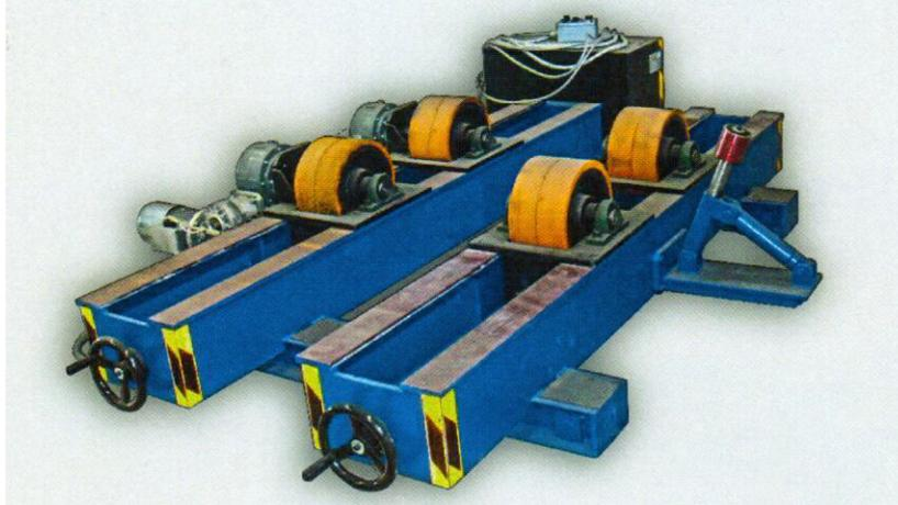
\* **DISPOSITIVO ANTIDERIVA con rullo gommato o in Fe di contrasto regolabile in altezza – montato normalmente sulla sezione motorizzata:**
