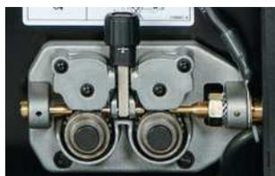
**Alimentatore resistente in fusione d'alluminio** integra un rullo trainafilo a due scanalature a cambio rapido, con tensionatore a molla e manopola di tensionamento calibrata, progettato per facilitare e velocizzare la configurazione.
